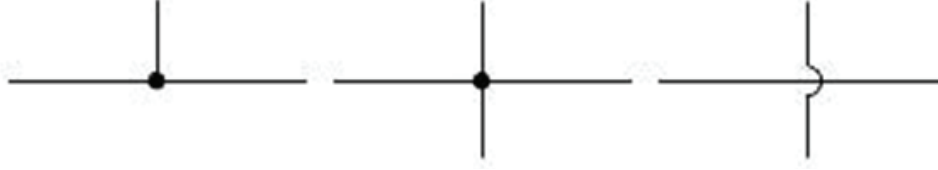
Şekil 5.10 Ekli ve eksiz olarak kesişen iletkenlerin gösterilişi
