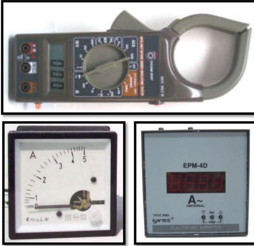
Resim 13.1 a-Dijital pano tipi ampermetre b-Analog ampermetre c- Pens ampermetre
